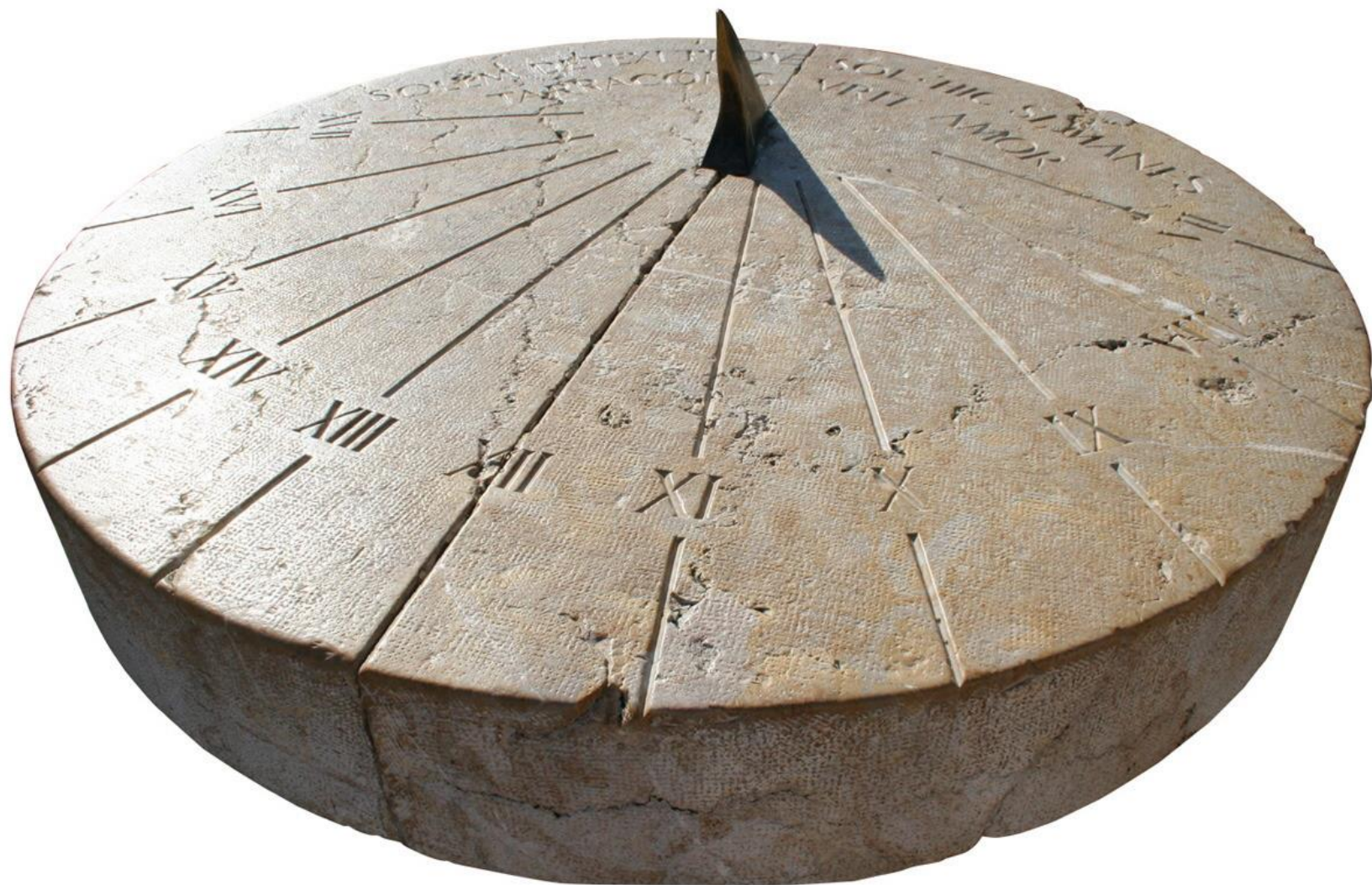
Zegar słoneczny z Hiszpanii z pierwszych wieków n.e. Cień nieruchomej wskazówki pada na tarczę oznaczoną podziałką i pokazuje godzinę.
